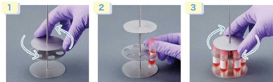
1 天面の蓋を左に回して上昇させます。 2 スクリューキャップチューブを差し込みます。 3 天面の蓋を右に回して下降させます。
