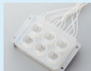
灌流アタッチメントへの装着イメージ。パーツ底面の孔により、アタッチメントの通気を保ちます。
